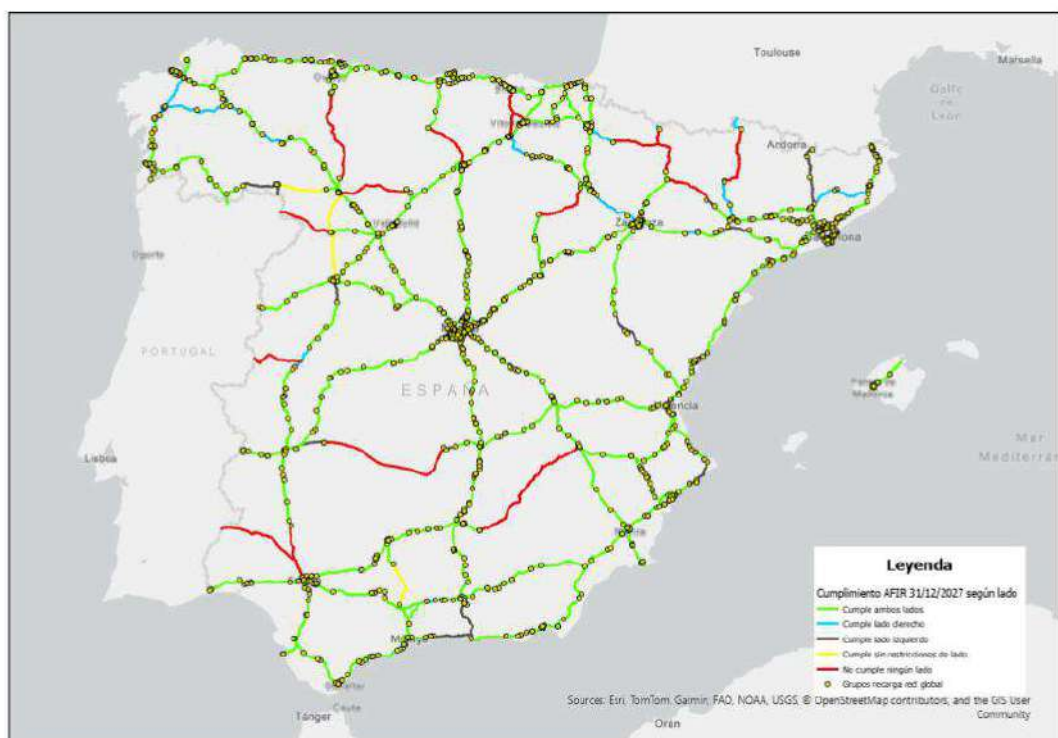
Figura 11. Cobertura según requerimiento de AFIR según el escenario probable a 2027 para la red global (grupos de al menos 300kW con al menos un punto de 150kW) en función del lado de la carretera en el que se sitúa el grupo de recarga y aplicando los posibles cambios de sentido
