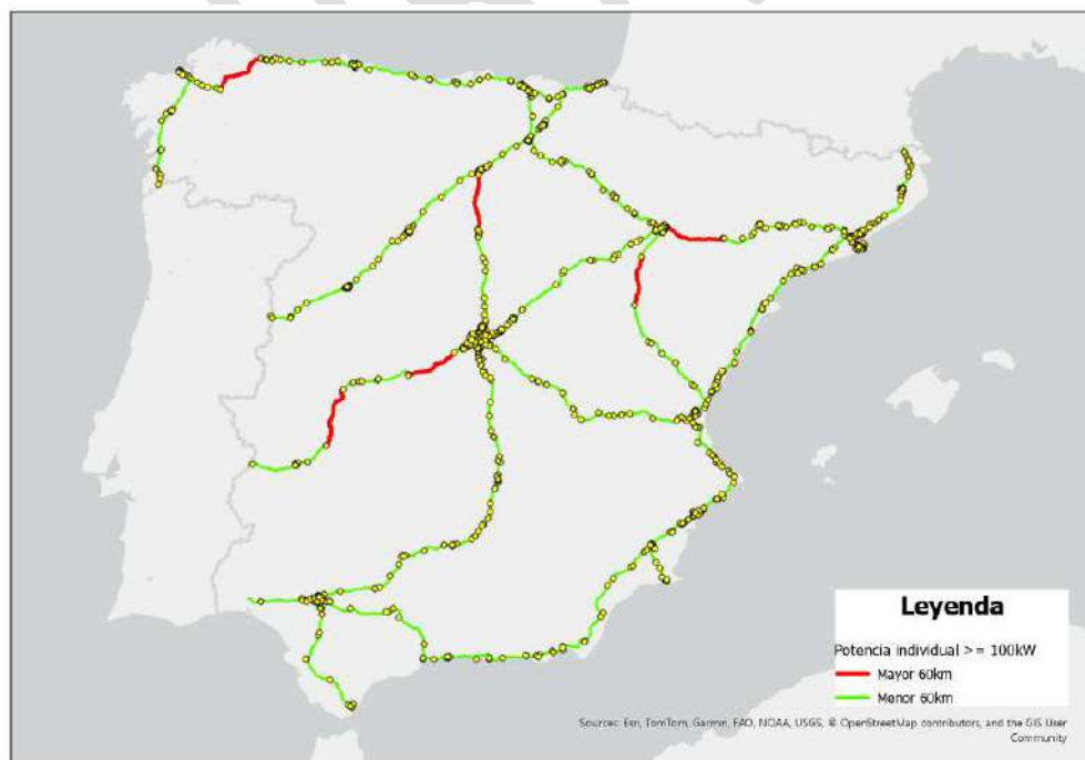
Figura 8. Clasificación de tramos de la red básica de la RTE-T, cada 60 km, con al menos 1 punto de 100 kW, sin tener en cuenta el sentido de circulación
