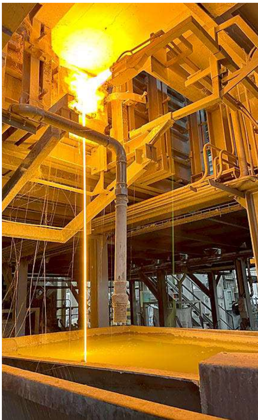
Una instalación de fabricación de fritas.
